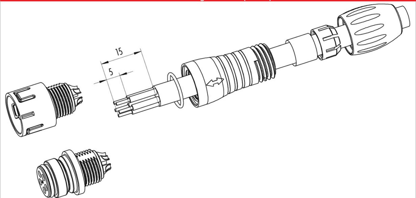
Description du produit **Snap-In IP67 connecteur de câble, Contacts: 12, 2.5 - 4.0 mm, Blindage est pas possible, soudure, IP67, VDE**
